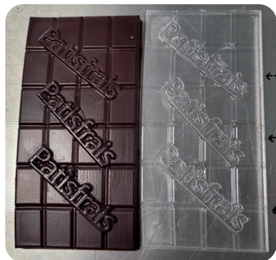
Le choix du matériau a joué un rôle central dans la réussite du projet. Après étude, nous avons retenu le PETG, un polymère offrant un équilibre pertinent entre résistance thermique, robustesse mécanique et stabilité dimensionnelle. Ce matériau se prête particulièrement bien aux contraintes du thermoformage, tout en répondant aux attentes en matière d'hygiène et de compatibilité avec les environnements alimentaires, sous réserve des validations réglementaires propres à chaque usage final.
